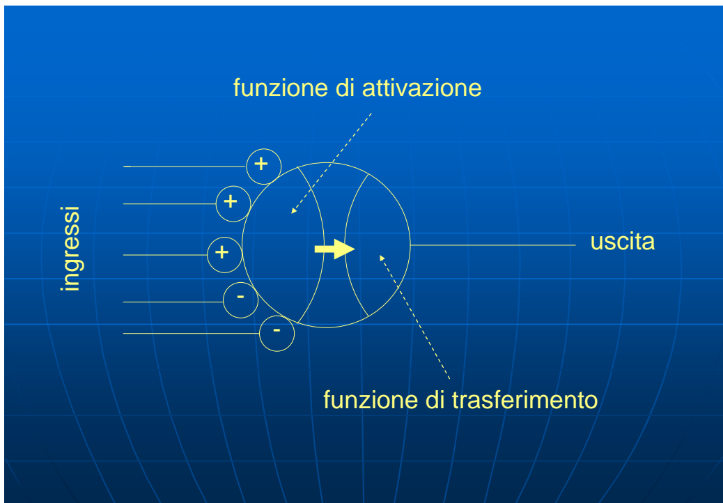
Figura 3. Schema del neurone artificiale. I segnali in ingresso vengono integrati dalla funzione di attivazione. La funzione di trasferimento riceve il segnale generato dalla funzione di attivazione, e lo invia all'uscita del neurone dopo averlo opportunamente modificato.
